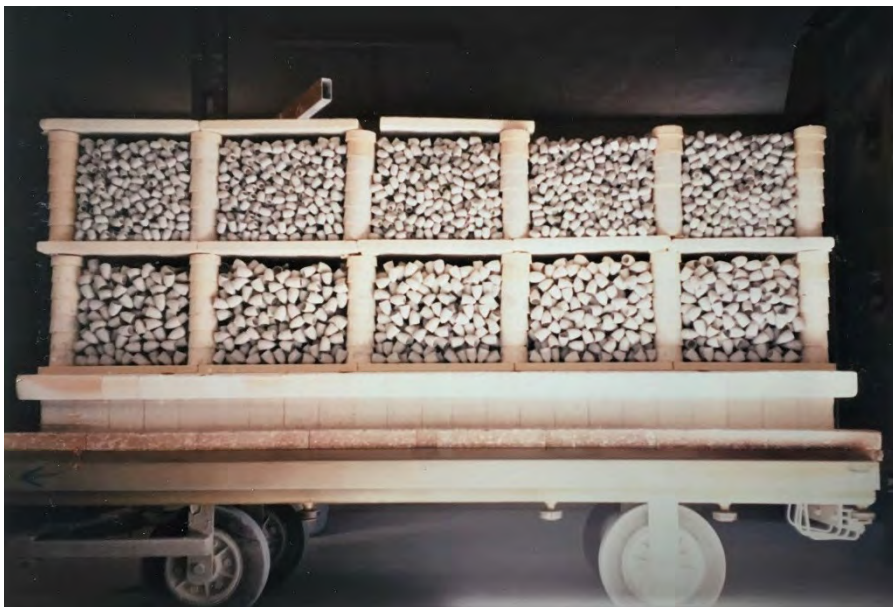
Afb. 30. Ovenkar geladen met ongebakken pijpen die zo de oven ingaat.
