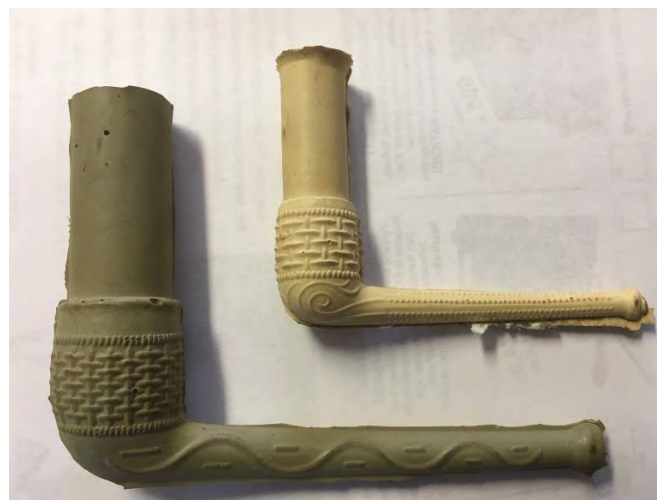
Afb. 26. Rubber basisvormen voor de vervaardiging van de stalen machinevormen. Foto auteur, eigendom firma Klauer.
